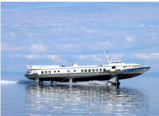
Современный быстроходный пассажирский теплоход на подводных крыльях
