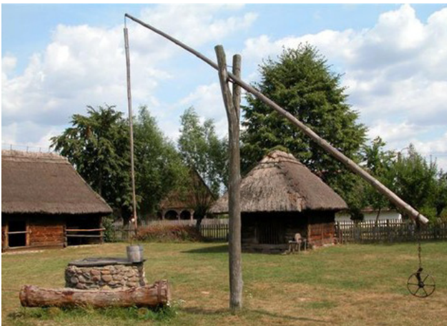
Традиционный деревенский колодец с «журавлем» для поднятия воды на поверхность Восточная Европа
