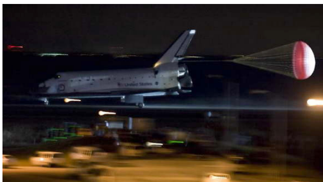
Завершается тормозной пробег американского космического челнока «Индевор». Справа на снимке хорошо виден тормозной парашют Март 2010 г.
